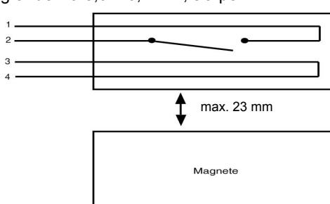
**Montaggio accessorio:** L'interruttore reed e/o magnete viene impiegato sulla struttura accessoria. Per stabilire il contatto occorre rompere la rientranza prevista nella parte superiore della struttura. Le viti di fissaggio vengono coperte per mezzo degli scodellini protettivi forniti e successivamente con i coperchi superiori della struttura. In caso di montaggio su base a conduzione magnetica occorre utilizzare viti antimagnetiche e accessori adatti (blocchi distanziatori).
