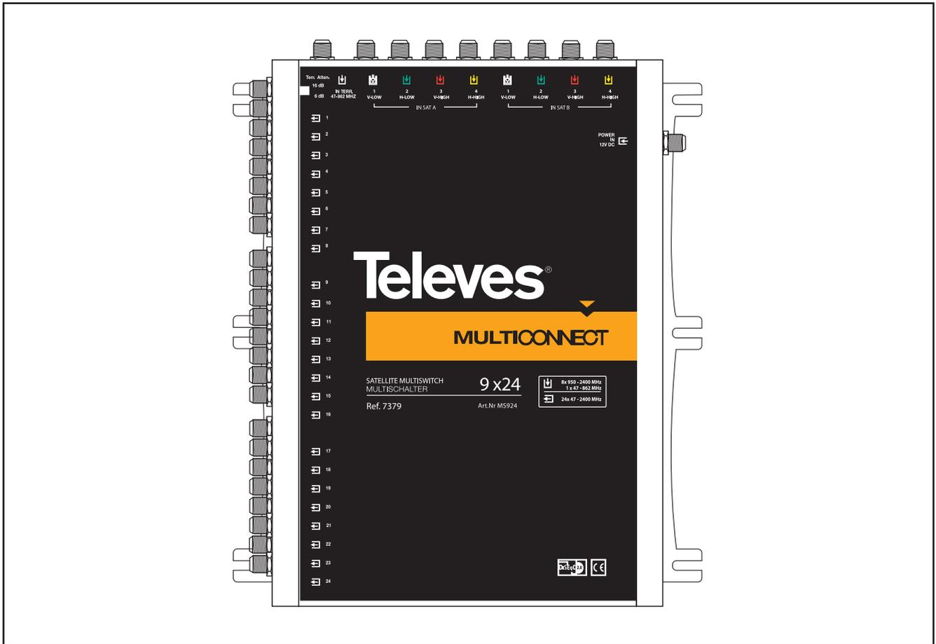
Este producto es un conmutador de 8 entradas 14V SAT A (pol. V; banda baja), 18V SAT A (pol. H; banda baja), 14/22KHz SAT A (pol. V; banda alta), 18V/22KHz SAT A (pol. H; banda alta), 14V SAT B (pol. V; banda baja), 18V SAT B (pol. H; banda baja), 14/22KHz SAT B (pol. V; banda alta), 18V/22KHz SAT B (pol. H; banda alta) y 24 salidas usuario.
