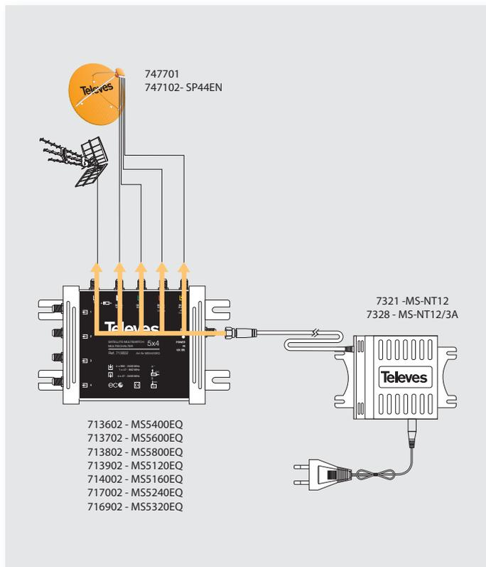
**Ejemplo de aplicación 2 / Exemplo de aplicação 2 / Exemple d'application 2 / Typical application 2 / Esempio di applicazione 2 / Anwendungsbeispiel 2 / Przykłady zastosowania 2 / Типовое применение 2**
