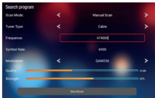
After selecting «Tuner Type» (Cable) and «Scan Mode», press «Start Scan», once and wait for a few minutes
