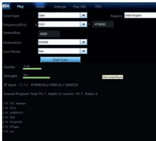
After selecting «Tuner Type» (Cable) and «Scan Mode», press «Start Scan» once and wait for a few minutes
