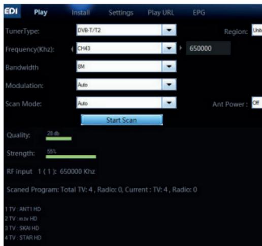
After selecting «Tuner Type» (DVB-T/T2) and «Scan Mode», press «Start Scan» once and wait for a few minutes
