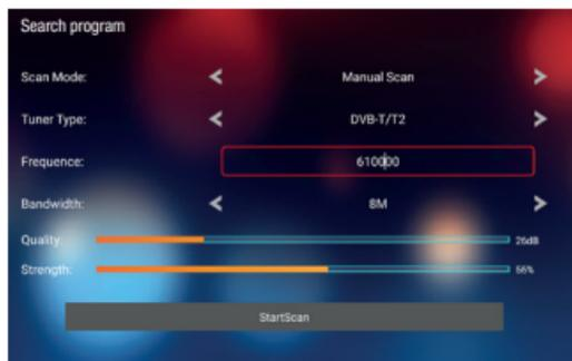
After selecting «Tuner Type» (DVB-T/T2) and «Scan Mode», press «Start Scan», once and wait for a few minutes
