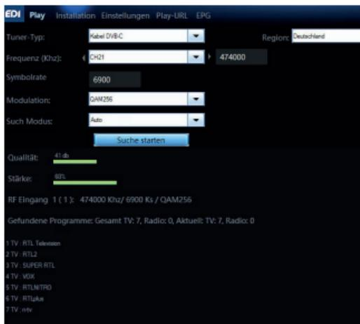
Nach der «Tuner-Typ» (Kabel DVB-C) und «Such-Modus» Auswahl, Drücken Sie «Suche Starten» und warten Sie ein paar Minuten
