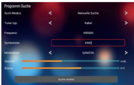
Nach der «Tuner-Typ» (Kabel) und «Such-Modus» Auswahl, Drücken Sie «Suche Starten» und warten Sie ein paar Minuten
